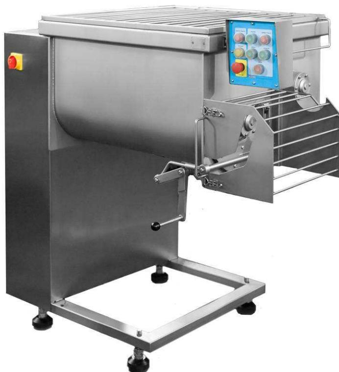
Фаршемешалка изготовлена полностью из нержавеющей стали, включая несущий каркас, обшивку и пульт. Стыки стенок дежи проварены изнутри сплошным швом с целью исключения залегания продукта и улучшения санобработки. Поверхности корпуса и дежи фаршемешалки – матовые, после дробеструйной обработки, имеют современный внешний вид. Месильный орган – валы с лопатками, расположенные на разных уровнях по высоте (85 мм). Привод – два необслуживаемых мотор-редуктора.
