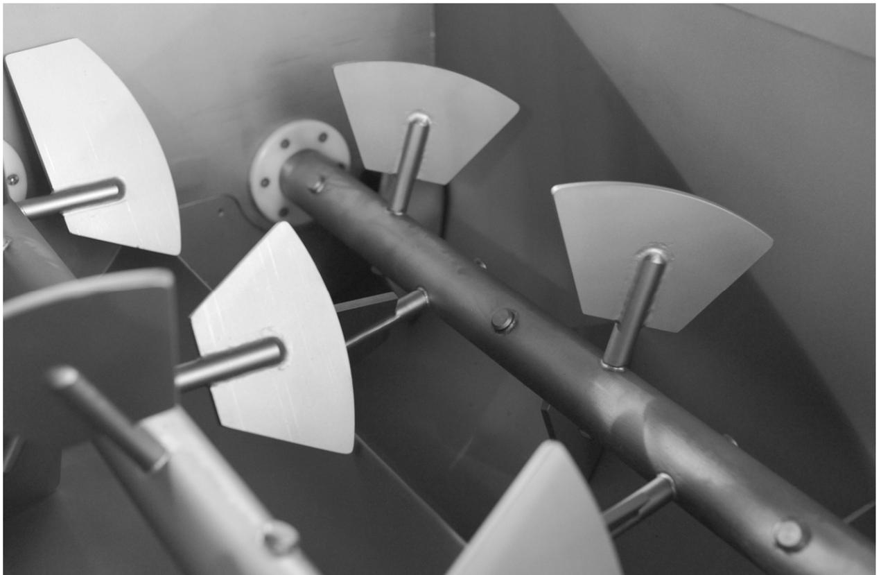
**Фото 3. Узел крепления вала и вид изнутри на шибер**
