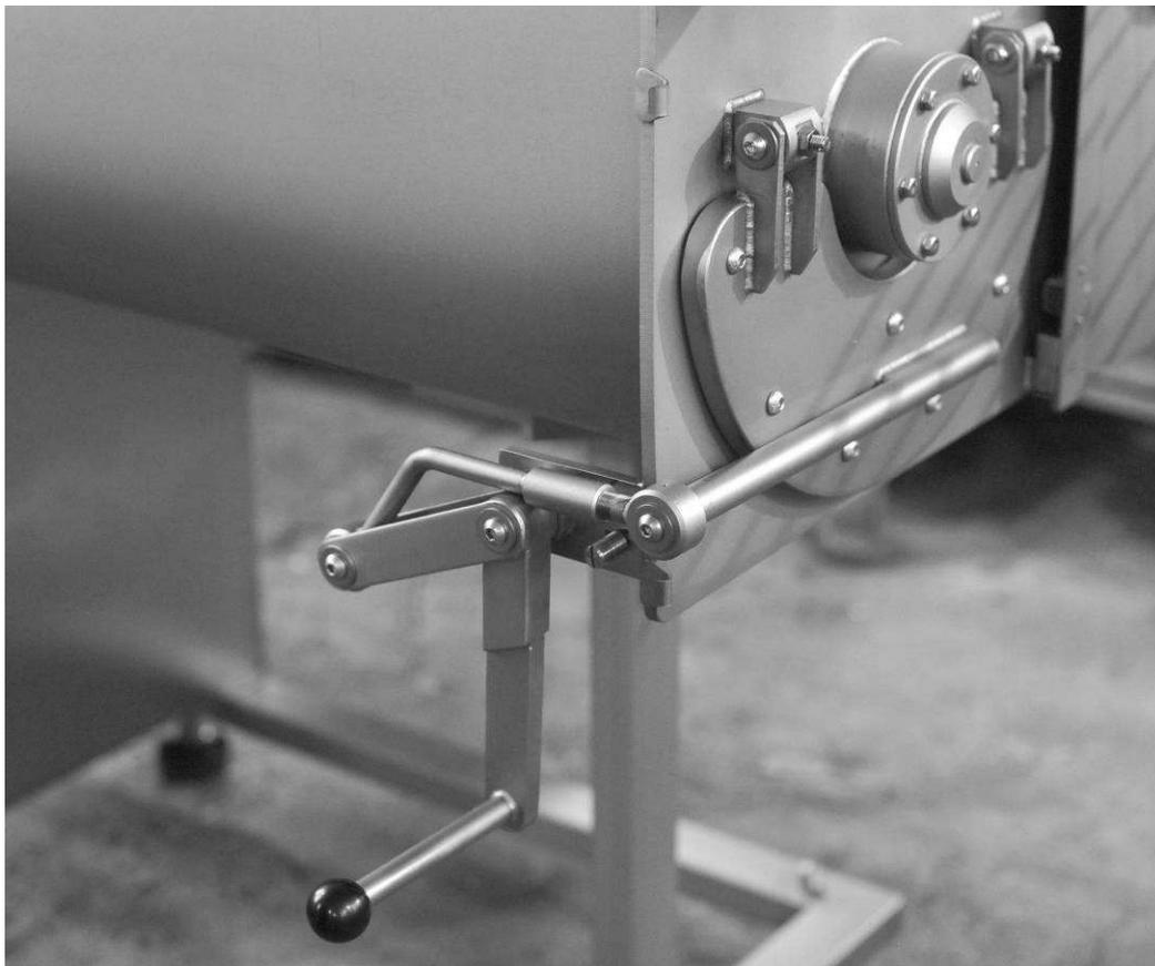
**Фото 5. Шибер закрыт (защитная решетка снята)**
